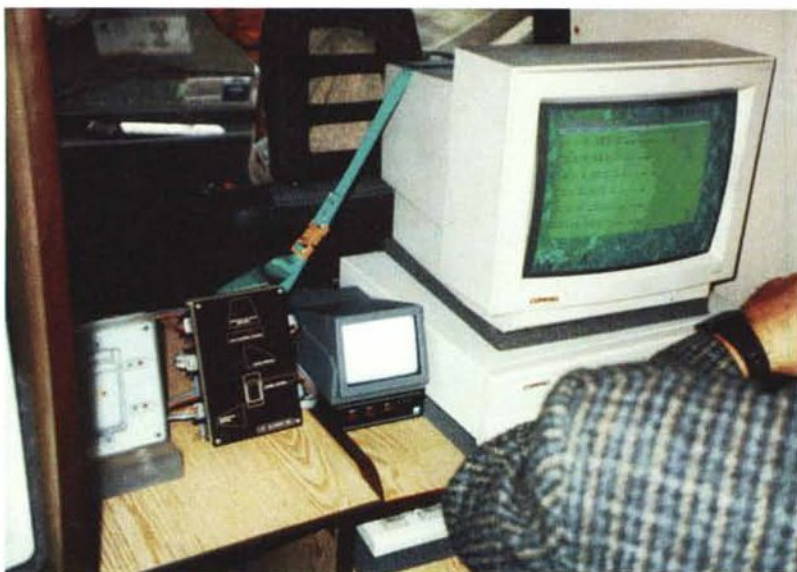
Anche i computer indossano le loro cinture di sicurezza. Si nota l'avvisatore luminoso dotato di LED colorati che segnala l'individuazione di ostacoli in relazione alla loro distanza e la situazione del veicolo rispetto alla segnalazione orizzontale presente sulla carreggiata stradale.
